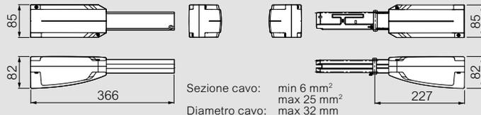
Sezione cavo: min 6 mm<sup>2</sup>
