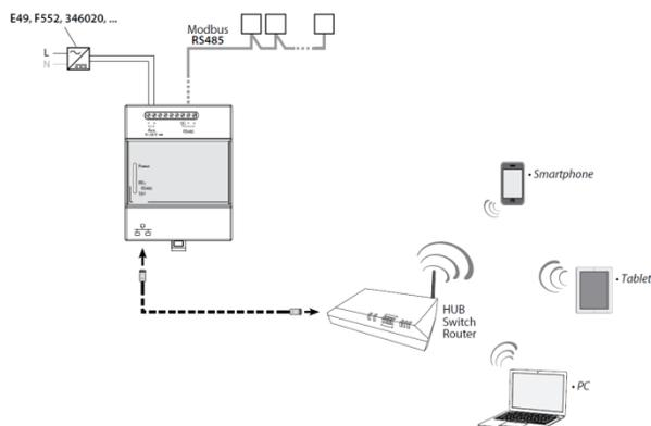
**Configurazione 2:** il Mini Web server è utilizzato come gateway Modbus/IP (alcuni dispositivi Modbus RS485 sono collegati direttamente alla porta RS485 del Web server) e come "Concentratore" di Gateway IP
