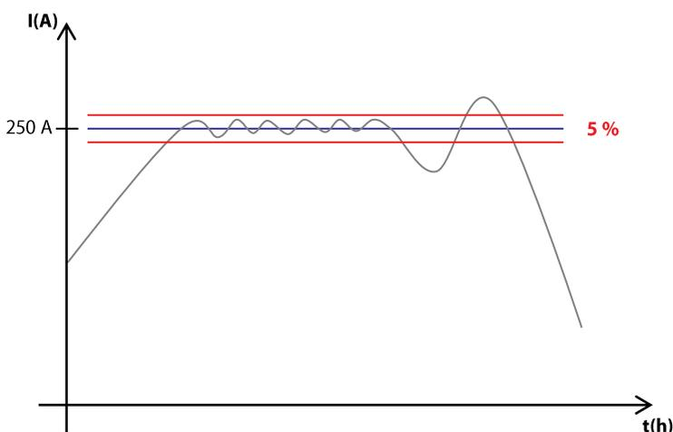
**Prima e Seconda sogli a di riduzione della corrente:** parametri utilizzati per definire la riduzione della corrente di carica quando il sistema si trova nell'area *gialla* o *rossa* (Valori di default 75% e 50%).
