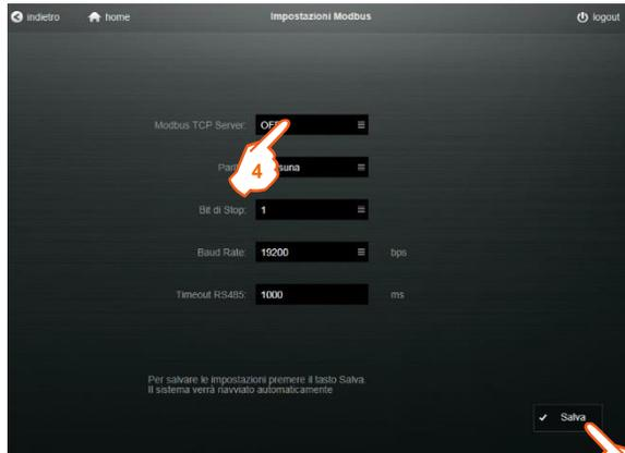
4. Cliccare per Abilitare (“ON”) il Server Modbus TCP utilizzato per la funzione Master/Slave
