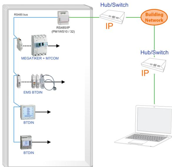
Esempio di schema di connessione "Configurazione 3"
