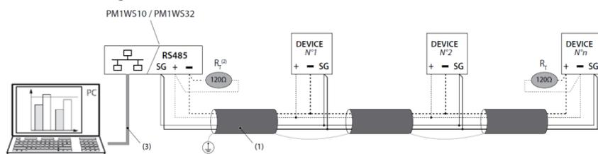
(1) RS485: Prescritto utilizzo di cavo tipo Belden 9842, Belden 3106A (o equivalente) per una lunghezza massima del bus di 1000 m, o di cavo Categoria 6 (FTP o UTP) per una lunghezza massima di 50 m;
