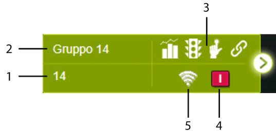
1. Indirizzo Modbus (Indirizzo Modbus - Posizione per contatori con uscita impulsi o Indirizzo Modbus - Lato per le Stazioni di ricarica a "due-lati" della vecchia gamma o Indirizzo Modbus - Indicazione del tipo di dispositivo virtuale per la funzione Master/Slave)
